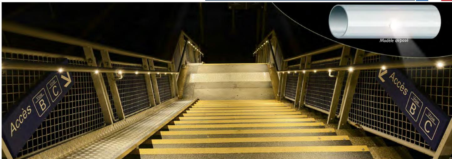
Le luminaire LED Architectural modèle **ATIK®** est un **luminaire LED encastré** de type cylindrique pour intégration dans un garde-corps.
